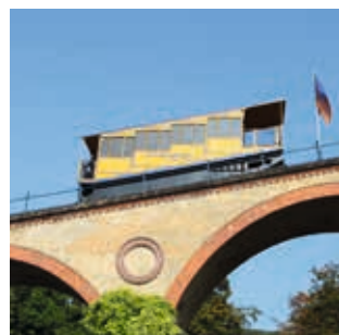
Wiesbaden In der hessischen Landeshauptstadt ist die bundesweit letzte Wasserlast- und Zahnstangenstandseilbahn in Betrieb. Die Nerobergbahn wurde 1888 errichtet und ist ein technisches Kulturdenkmal.
